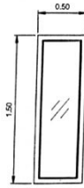
บานกระดาดตาย วงกบอลูมิเนียมมีงาสายตา กระดาดผ่า หน้า 5 มม.
